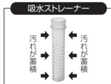
⚠ 吸水ストレーナーに付着したゴミや汚れ(腐敗した水草や魚の排出物、エサの残りなど色々な汚れが蓄積していきます。)は定期的に取り除いてください。吐出量の低下や水中ポンプの故障の原因となります。
