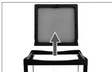
スクリーンフレームを90度起こしてから真上に引き抜くと外れます。
