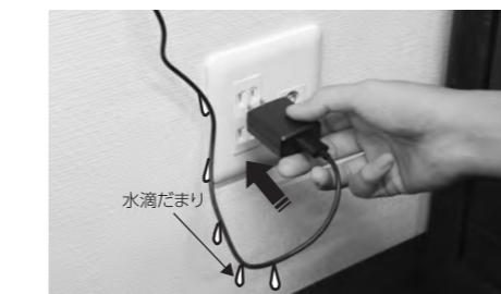
その際、水槽側から伝った水滴を防ぐために、コードに水滴だまりを設けてください。また、USBアダプタのUSB端子差し込み口に水が入らないように注意してください。
