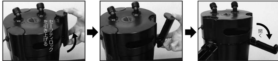
3箇所のセーフティロックを外します。外し方はセーフティロックの下部に指をかけて引き上げて外します。セーフティロックは密閉性を保つ為、多少固く締まっています。
