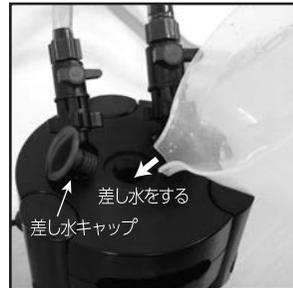
モーターヘッドの取り付け、バルブタップの装着後(レバーは閉じたまま)に差し水キャップを回して開けます。その後、穴から差し水をしフィルターボックス内を満水にして差し水キャップを開めます。(水を入れる際、ゆっくり水位を確認しながら入れてください。)
