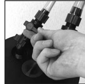
吸水側(IN)のバルブタップのレバーを閉じたら、送水側(OUT)のレバーを閉じます。
