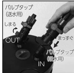
吸水用(IN)と送水用(OUT)を確認し、バルブタップをバルブベースにまっすぐ差し込み、バルブタップ下部のネジを回して接続します。
