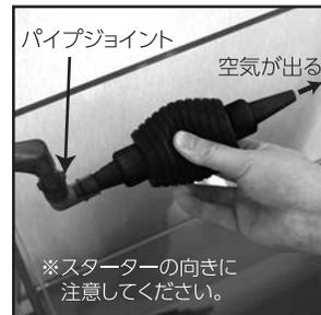
スターターポンプでフィルターボックス内に呼び水をし、フィルターボックス内と吸水・送水のホースに水が満水になった事を確認し電源プラグを差し込み再始動させます。(11~12ページ参照)
