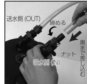
バルブタップのナットを右に回しきった状態にし、ホースを差し込みます。吸水側(IN)と送水側(OUT)に注意し、ホースを奥まで差し込み、ナットを左に回して締めてください。
