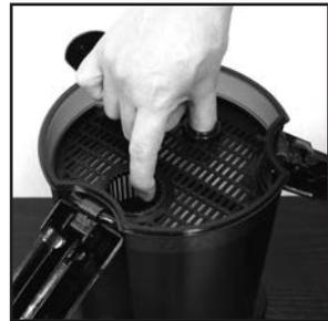
モーターヘッドを外したら、インナーバスケットからインナーカバーを取り出します。
